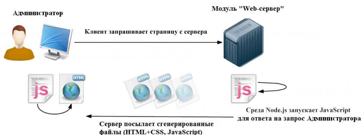
Рисунок 5 - Общая схема взаимодействия с веб-сервером node.js
